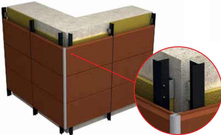
Dış köşe detayı Внешняя угловая деталь
